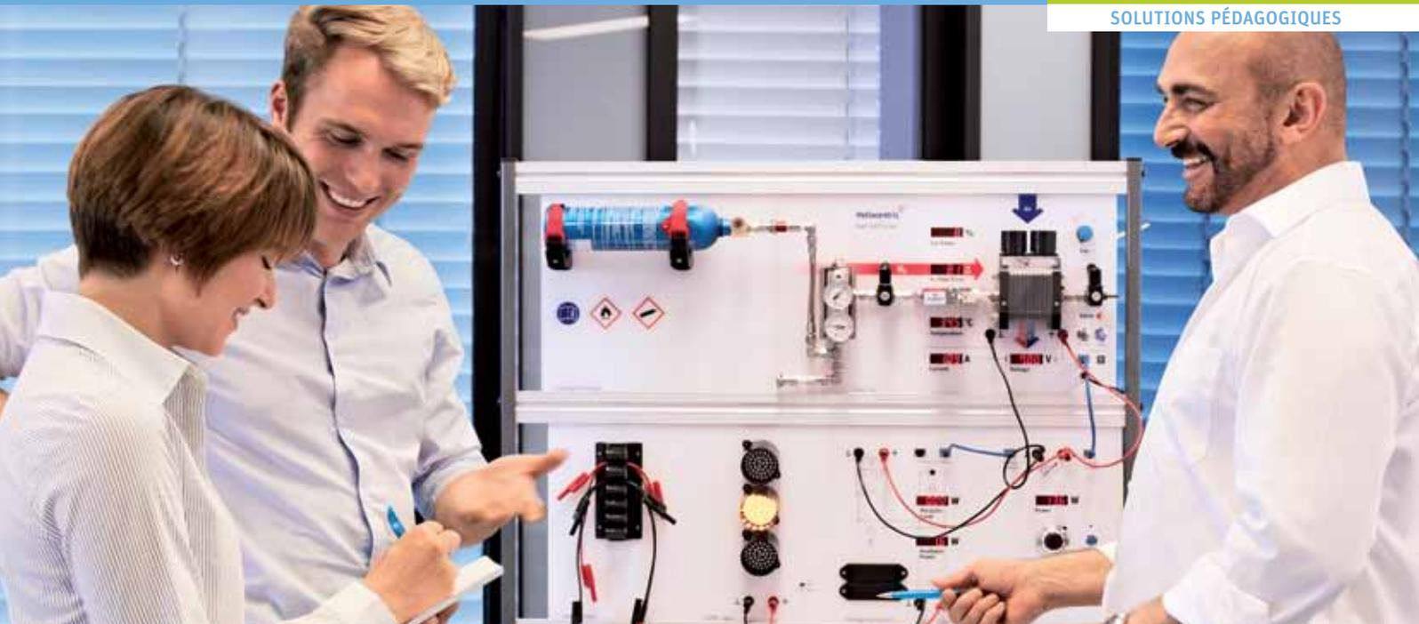
Le Fuel Cell Trainer d'Heliocentris convient parfaitement à l'enseignement des principes fondamentaux des systèmes à pile à combustible. Ses nombreuses capacités d'exploitation et son guide d'expérimentation en font un système de formation complet, aussi bien pour les enseignants (démonstration) que pour les étudiants.
